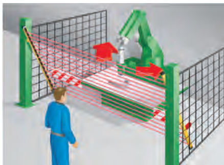
在一个工业机器人上进行危险点保护
